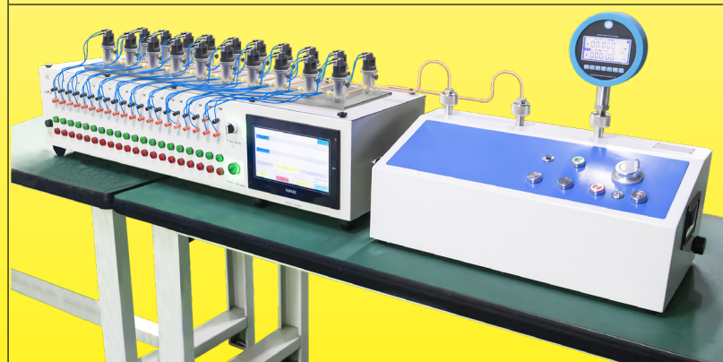
Verifica della calibrazione del pressostato
